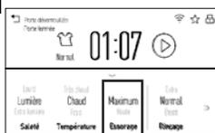
En changeant le réglage d'essorage, vous changez la vitesse de l'essorage final des cycles. Suivez toujours les instructions de l'étiquette du vêtement pour changer le réglage d'essorage.
