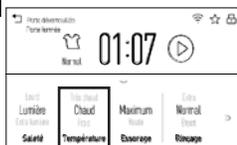
Ajustez pour choisir la bonne température de l'eau pour le cycle de lavage. L'eau de pré-lavage et de rinçage est toujours froide pour réduire l'utilisation d'énergie et diminuer la fixation des taches et les froissements.
