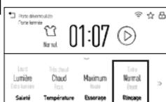
Une modification du rinçage (Rinse) changera le nombre de rinçages qui seront utilisés par un cycle. Pour changer le réglage du rinçage, repérez la section du rinçage (Rinse) sur l'écran du cycle et faites défiler vers le haut ou le bas jusqu'à trouver le réglage désiré. Vous pouvez choisir entre Normal (Normal), Extra (Supplémentaire) et No rinse (aucun rinçage).
